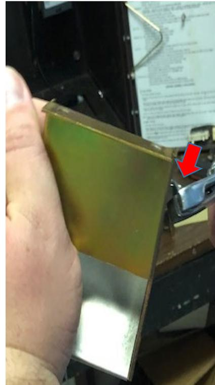
USE PLIERS TO STRAIGHTEN ONE END OF THE FLIP DOOR RETAINING PIN
